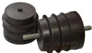
Опорный ребристый полимерный изолятор ИОРП 1-2,5 УЗ, предназначен для изоляции и крепления токоведущих частей в электрических аппаратах и комплектных распределительных устройствах номинальным напряжением до 1000 В частотой до 60 Гц для работы в районах, расположенных на высоте до 1000 м над уровнем моря.
